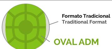
Gracias al **diseño Oval** aplicado en segmentos ADM, conseguimos herramientas con un diámetro standard adaptable a todas las máquinas existentes. **Incrementamos exponencialmente la capacidad de trabajo, reduciendo los tiempos y por consiguiente el coste** de pulido.
