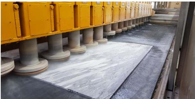
Aprovechamiento de la base metálica Frankfurt para posteriores recargas de los BIT diamantados, **reduciendo considerablemente el coste** de la herramienta y su transporte. Su **facil intercambio** hacen de este sistema la solución para **configurar** la herramienta a gusto del usuario **según sus necesidades**.
