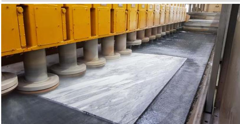
Aprovechamiento de la base metálica Frankfurt para posteriores recargas de los BIT diamantados, **reduciendo considerablemente el coste** de la herramienta y su transporte. Su **fácil intercambio** hacen de este sistema la solución para **configurar** la herramienta a gusto del usuario **según sus necesidades**.
